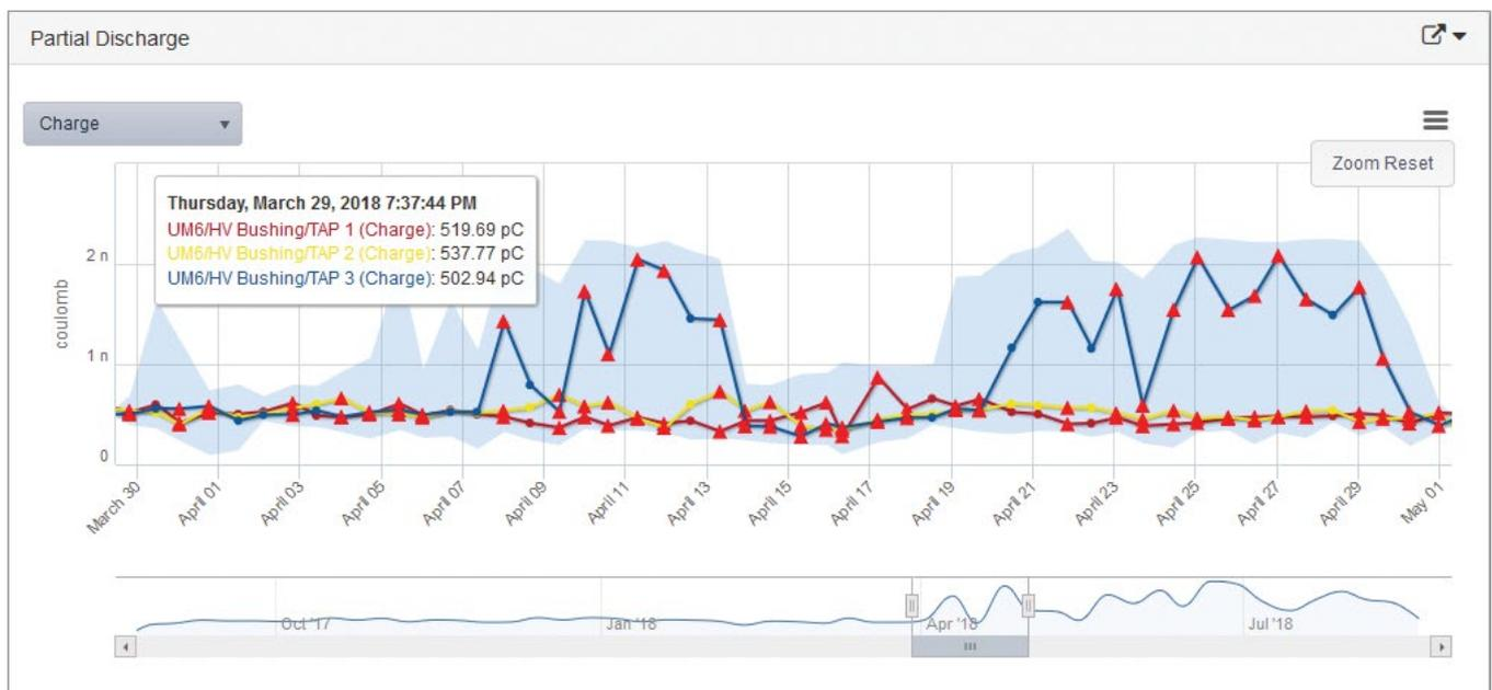
TE-Trenddiagramme für die einzelnen Phasen oder Kanäle. Anzeige von TE-Werten und Vergrößern für weitere Details durch Scrollen über Datenpunkte.
