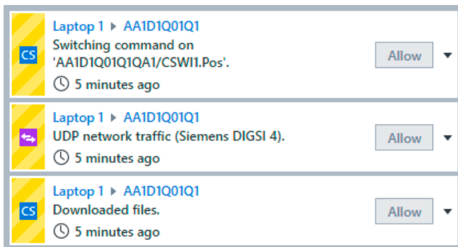
Figura 6: Datos de la figura 5: Portátil desconocido intentando un control no autorizado de un interruptor de potencia
