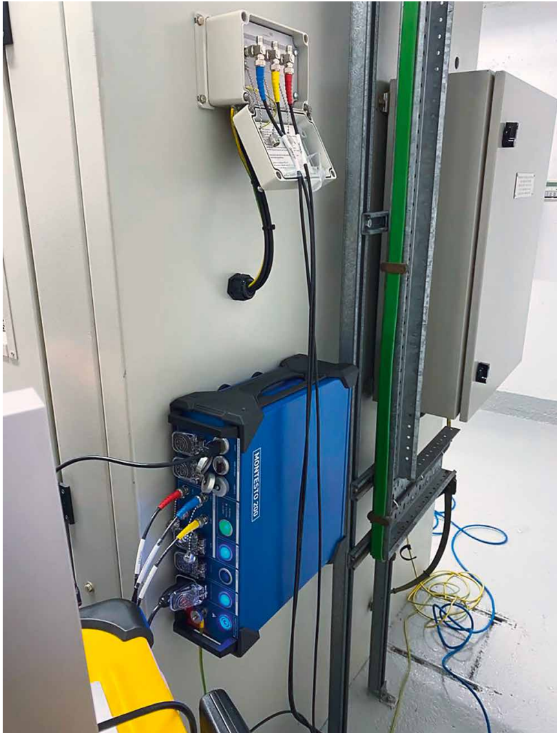
Le MONTESTO 200 peut être facilement monté sur l'équipement pour une surveillance continue en ligne des DP sur de longues durées.
