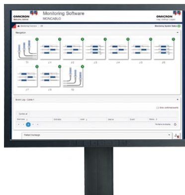
Zentraler Computer mit OMS-System- und Monitoring-Software
