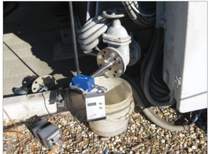
Ablassventil-Sensor zum vorübergehenden Einsetzen in den Transformator für UHF-Messung von Teilentladungen
