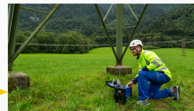
Mesure de la résistivité du sol
