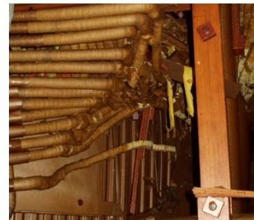
Verschobene innere Verbindungen
