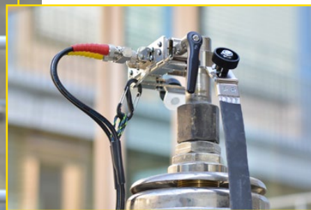
Spezielle angefertigte Durchführungsklemmen sorgen für einen zuverlässigen Kontakt.
