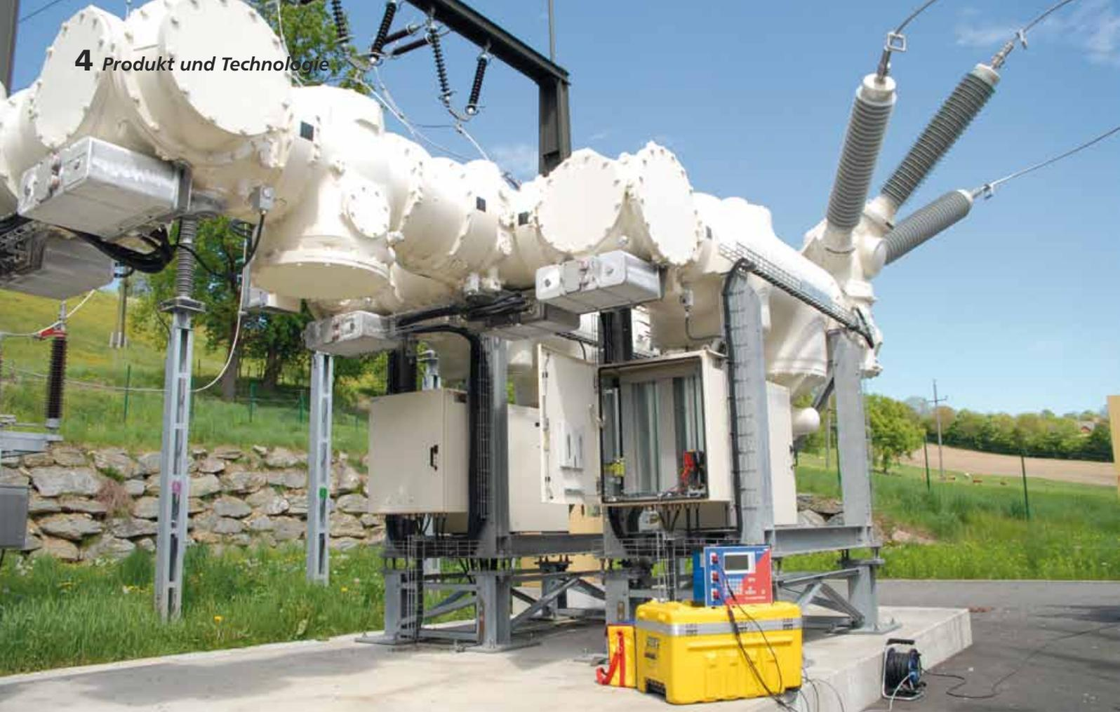
Eine neue Methode zum Prüfen von Stromwandlern
