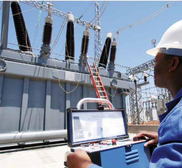
**Kompakt:** Das OMICRON CPC 100 mit eingebautem 5 kVA-Leistungsverstärker ermöglicht die effiziente Prüfung von Leistungstransformatoren im Feld.
