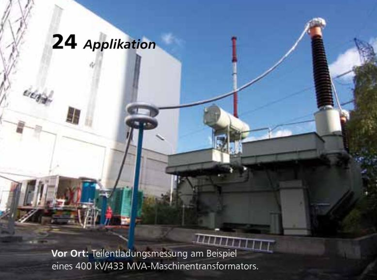
**Vor Ort:** Teilentladungsmessung am Beispiel eines 400 kV/433 MVA-Maschinentransformators.
