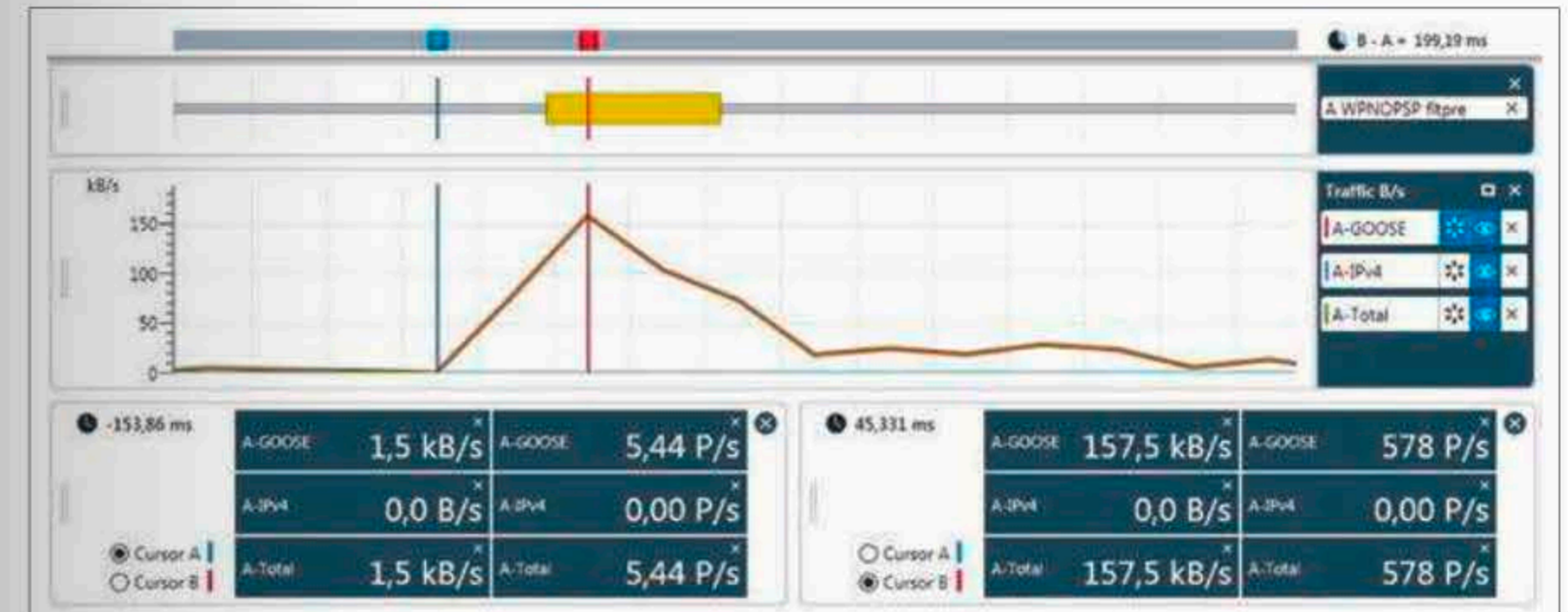
(Figura 1) El análisis de utilización de la red realizado con DANE0 400 muestra el número de paquetes enviados por segundo, así como el volumen de datos antes y durante el error.
