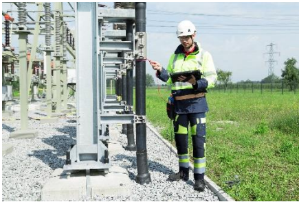
Rápida y fácil medición de la tensión de paso y contacto usando el equipo HGT1 y el software PTM
