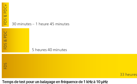
Figure 7 : Temps de test pour un balayage en fréquence de 1 kHz à 10 \mu Hz
