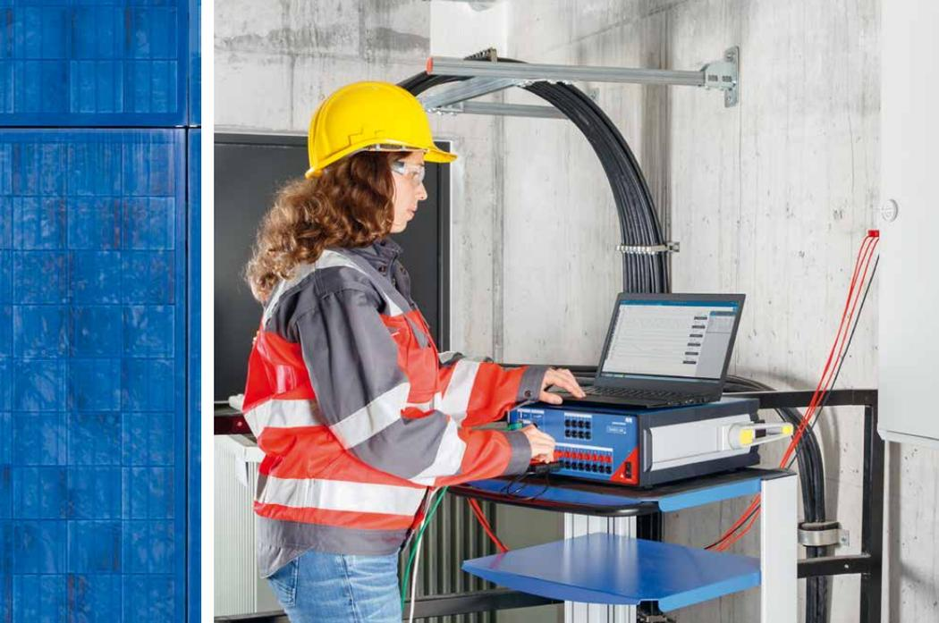
Uno de los puntos de medición estaba localizado directamente en el transformador y los terminales de suministro del proveedor de energía para poder detectar las perturbaciones tanto procedentes de la red de media tensión como dentro de la misma.
