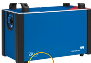
Equipamento de teste Tan Delta (fator de potência)
