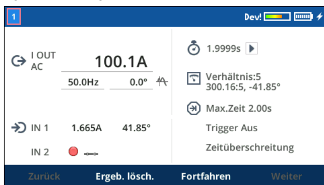
Ergebnis der Messung des Stromwandlerverhältnisses
