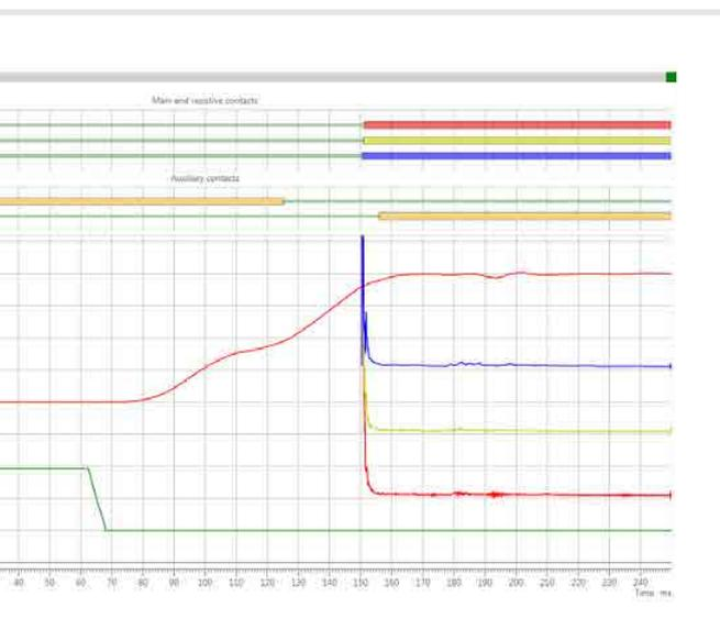
Die Primary Test Manager™ Software zeigt die Ergebnisse der Schaltzeitenmessung mit CIBANO 500 und der CSM-Methode.
