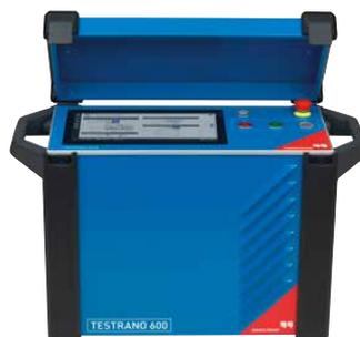
« Le TESTRANO 600 est un équipement de test très flexible, conçu pour rendre les tests des transformateurs simples et efficaces. »
