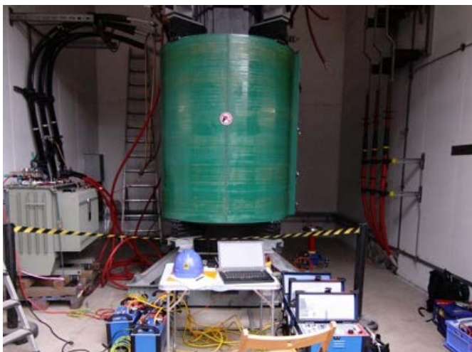
Figura 11. Medición de DP en un transformador de resina de 17 MVA usando tres unidades CPC 100
