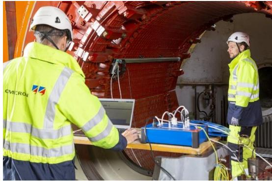
Während längerer Stillstände für die Instandhaltung wird die Streuflussmessung am Blechpaket mit dem multifunktionalen Prüfgerät *CPC 100* von OMICRON und der *Upgrade-Option für die Messung des Ständerkerns* durchgeführt.
