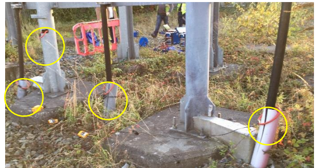
Figure 14 : Mesure primaire d' I_p à l'aide de 4 bobines Rogowski
