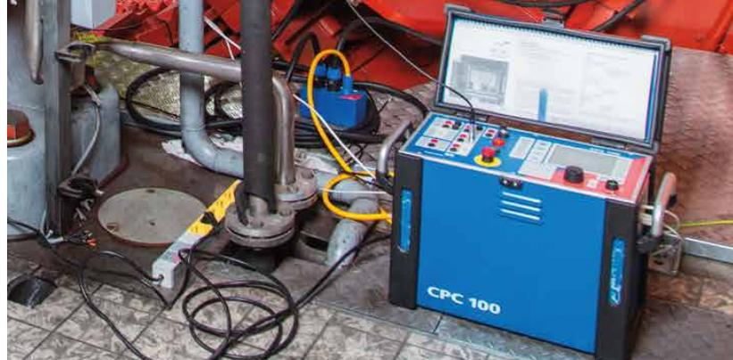
«Si hay alguna imperfección en el núcleo del estator, se detecta de forma confiable con la ayuda de la medición del flujo de dispersión».
